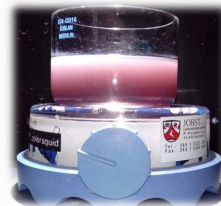
Fotokatalitička razgradnja bojila RR45 pomoću \text{PANI/TiO}_2 fotokatalizatora na simulatoru Sunčevog zračenja
