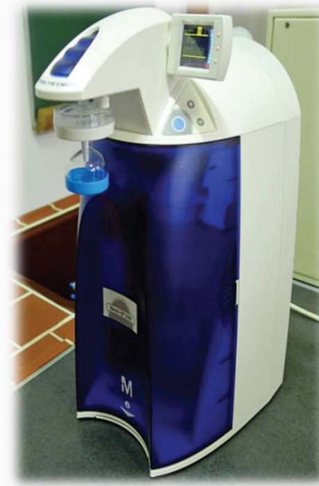
Uređaj za dobivanje ultračiste vode Milipore Direct-Q 3
