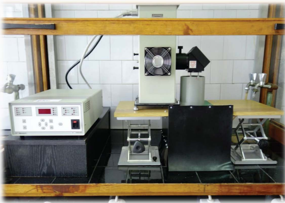
Simulator Sunčeva zračenja Oriel Newport (Osram XBO 450W lampa)
