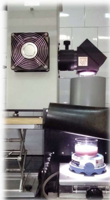
Fotokatalitička razgradnja bojila RR45 pomoću \text{TiO}_2 fotokatalizatora imobiliziranog na lebdećem pepelu (FA)
